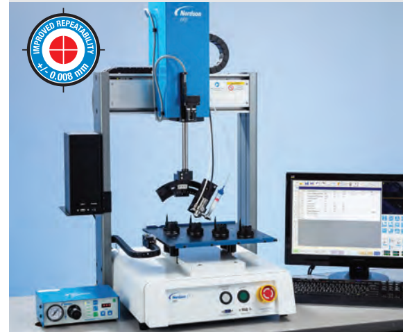
RV 시리즈 CCD 스마트 비전 카메라는 작업물 유무와 방향을 확인합니다.
